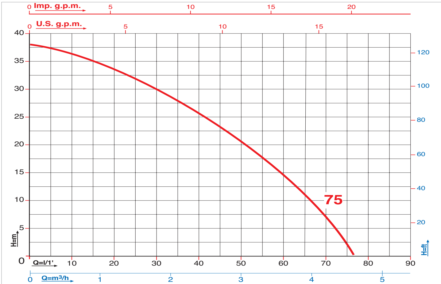
Caratteristiche di funzionamento a 2800 rpm 50Hz e 3450 rpm 60Hz - Performances at 2800 rpm 50 Hz and 3450 rpm 60 Hz Le prestazioni valgono per liquidi con densità \rho = 1,0 \text{ kg/dm}^3 ed una viscosità \nu = 1 \text{ mm}^2/\text{s} / The performance data holds true for liquids with a \rho = 1,0 \text{ kg/dm}^3 density and a \nu = 1 \text{ mm}^2/\text{s} viscosity.
