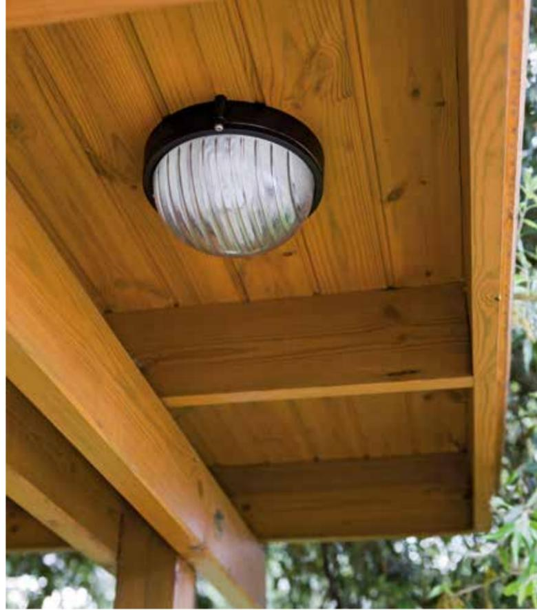
Plafoniera con struttura in pressofusione di alluminio. Diffusore in vetro stampato. Versione piccola adatta per lampada con altezza massima 105 mm, versione grande adatta per lampada con altezza massima 155 mm (non inclusa).
