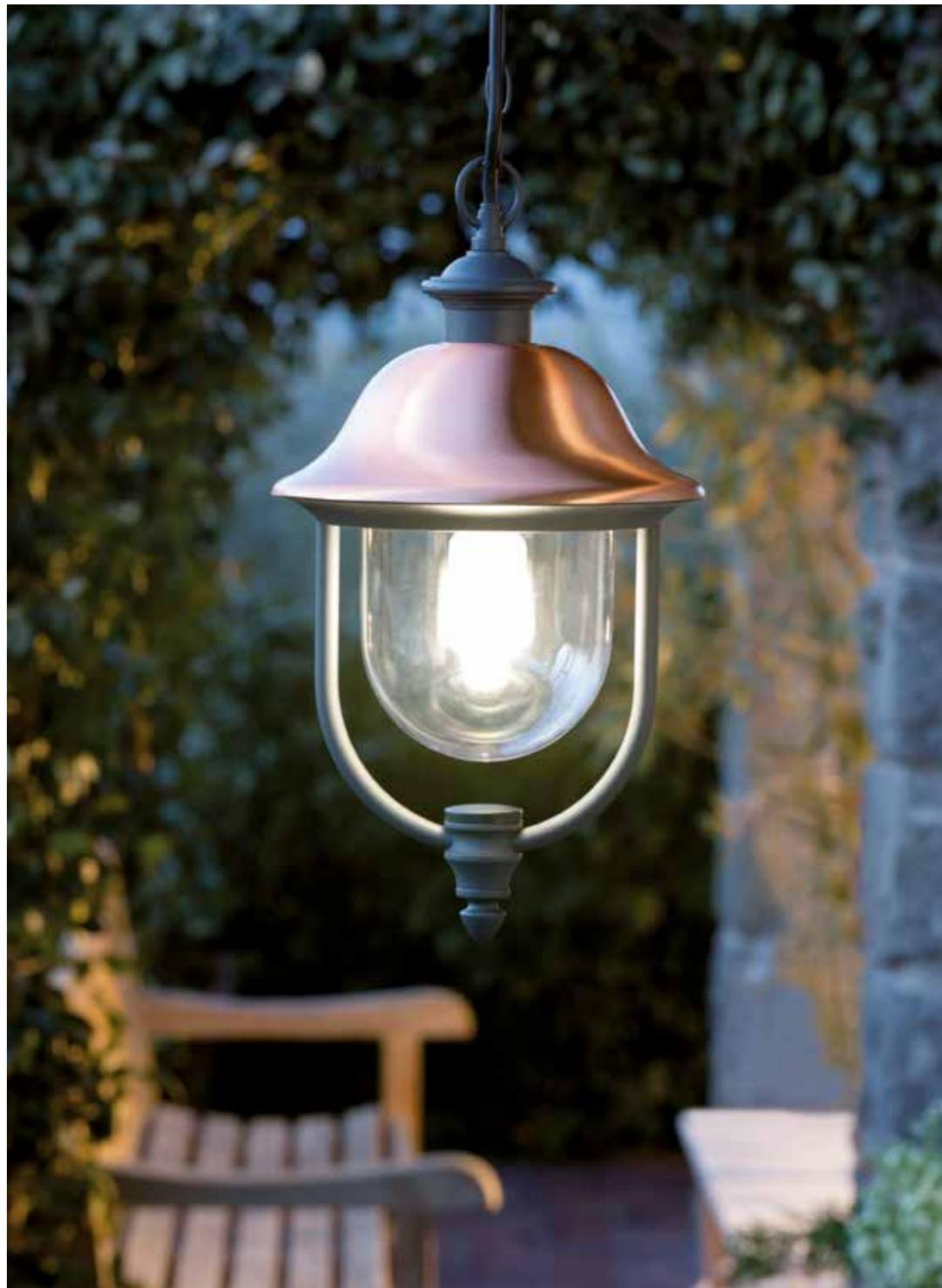
Sospensione con struttura in pressofusione di alluminio. Copertura superiore in rame. Diffusore in termoplastico trasparente. Cavo H05RN-F 3G1. Paletto da cancello con dispositivo di connessione. Versione testa-palo con manicotto diametro 60 mm e dispositivo di connessione. Adatta per lampada con altezza massima 150 mm (non inclusa).
