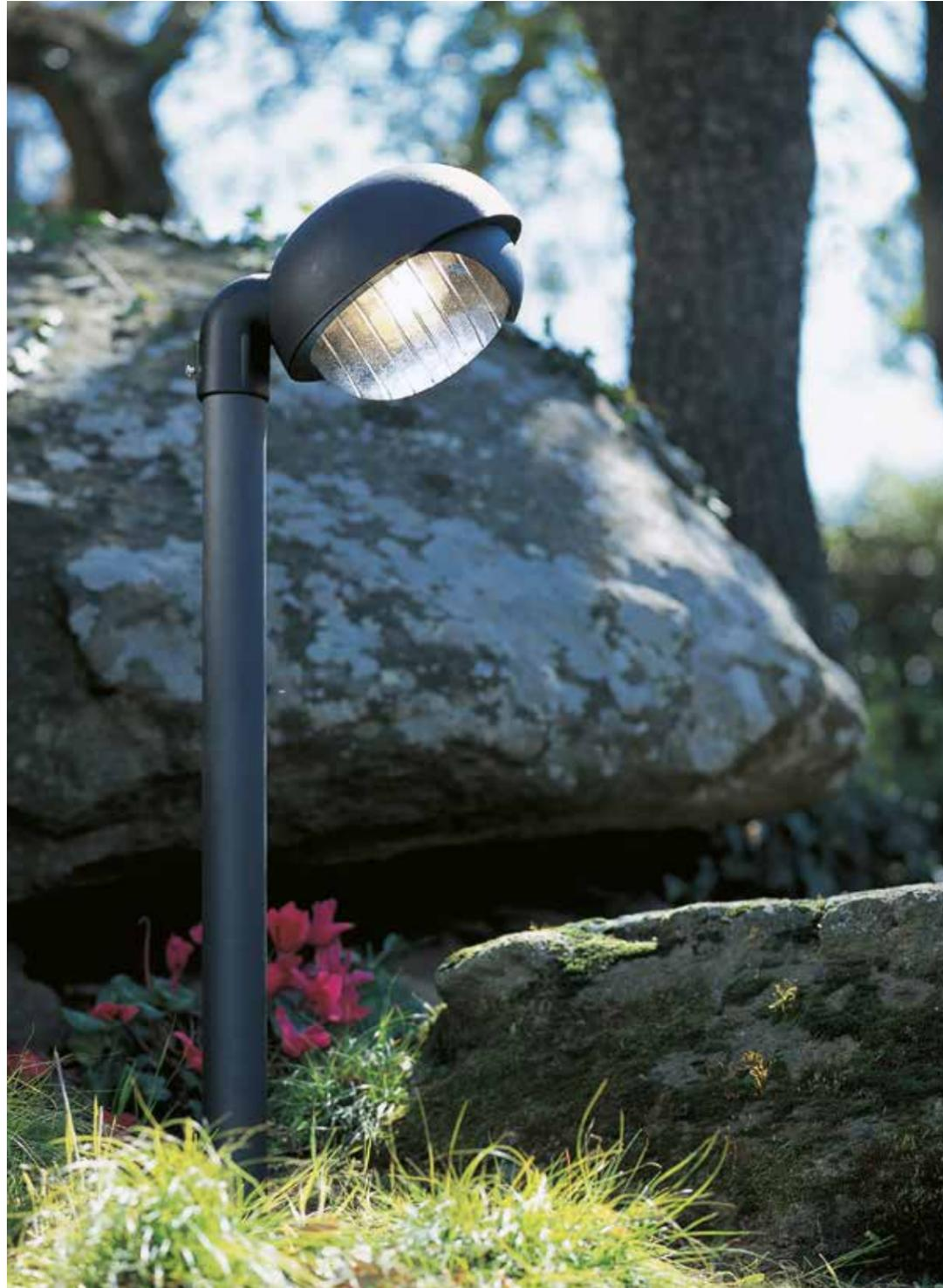
Testa-palo con struttura in termoplastico. Diffusore in vetro stampato. Manicotto diametro 60 mm e dispositivo di connessione. Versione con vetro tondo adatto per lampada con altezza massima 155 mm, versione con vetro ovale adatto per lampada con altezza massima 170 mm (non inclusa).
