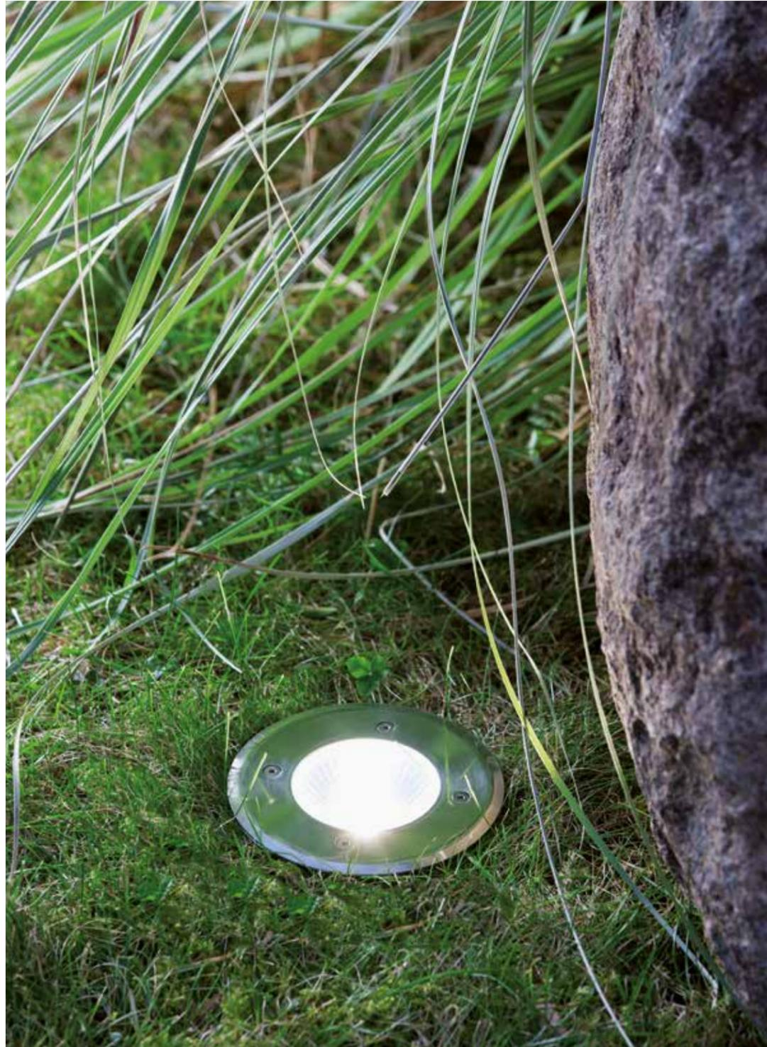
Incasso da pavimento, Calpestabile, in pressofusione di alluminio. Disco in acciaio inox. Diffusore in vetro trasparente infrangibile (Max 500 kg). Parabola riflettente in alluminio. Pressacavo PG7. Controscatola in termoplastico, guarnizione siliconica. Versione piccola con illuminazione a 1 LED COB 3 W, media con illuminazione a 1 LED COB 5 W, grande con illuminazione a 1 LED COB 7 W.
