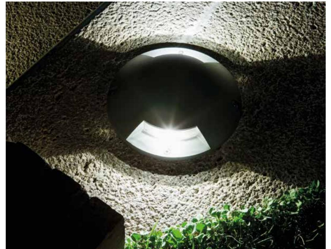
Lampada segna passo in alluminio calpestabile (max 500 kg). Diffusore in termoplastico trasparente. Picchetto di supporto incluso. Pressacavi PG9. Versione 1 apertura con illuminazione a 1 LED SMD 1 W, versione 2 aperture con illuminazione a LED SMD 2x1 W (2 W), versione 4 aperture con illuminazione a LED SMD 4x1 W (4 W).
