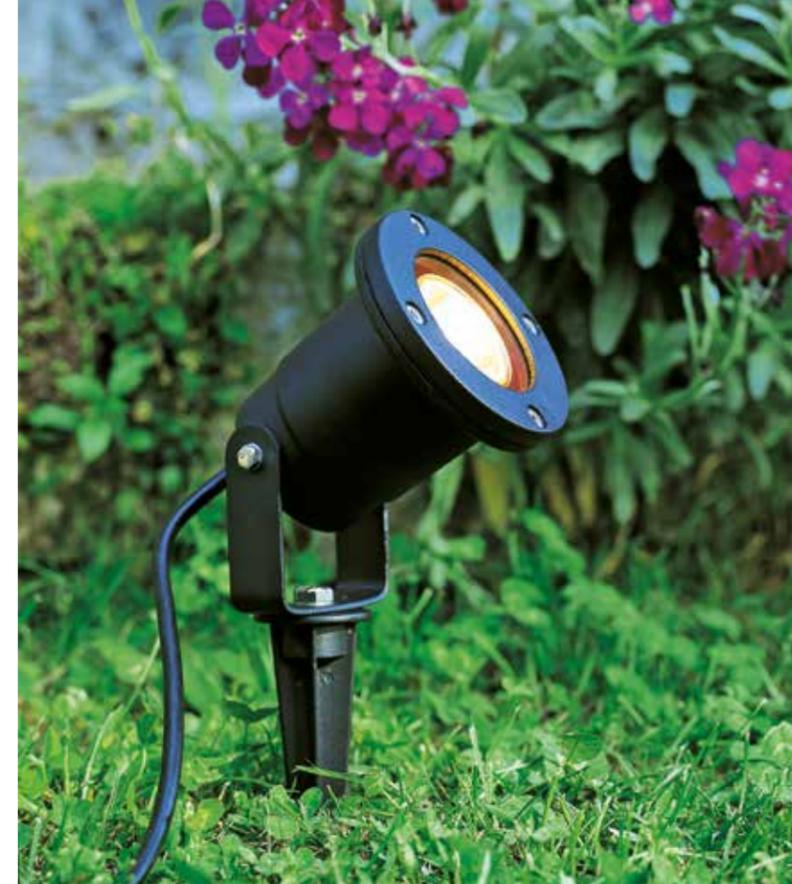
Faretto orientabile con staffa per fissaggio, struttura in pressofusione di alluminio. Diffusore in vetro trasparente. Pressacavo PG7. Versione con picchetto fornita di cavo da mt 2 H05RN-F 3G1 con spina schuko. Adatto per lampada con altezza massima 57 mm. Lampada 50 W inclusa alogena dicroica luce calda.
