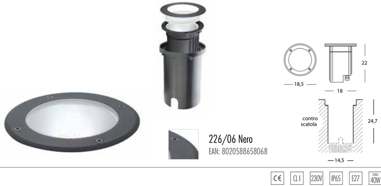
Incasto da pavimento, Calpestabile, in pressofusione di alluminio. Diffusore in vetro trasparente infrangibile (Max 500 kg). Parabola riflettente in alluminio. Pressacavo PG11. Controscatola in termoplastico, guarnizione siliconica. Adatto per lampada con altezza massima 145 mm (non inclusa).
