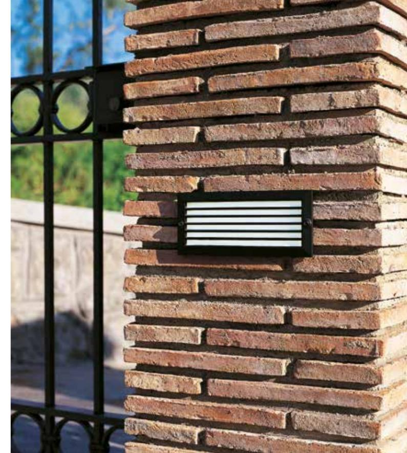
Incasto a parete con struttura in pressofusione di alluminio. Diffusore in vetro satinato bianco. Controscatola in termoplastico. Versione con griglia frangiluce. Adatta per lampada con altezza massima 140 mm, diametro massimo 45 mm (non inclusa).
