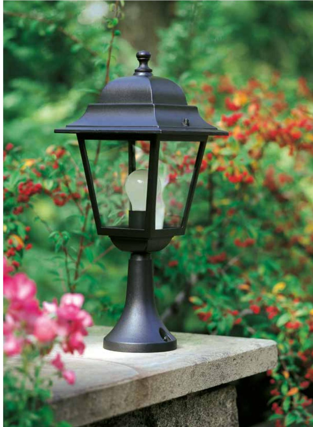
Paletto da cancello con struttura in pressofusione di alluminio. Diffusori in vetro trasparente. Dispositivo di connessione. Versione testa-palo con manicotto diametro 60 mm e dispositivo di connessione, versione a sospensione con cavo H05RN-F 3G1. Adatta per lampada con altezza massima 210 mm (non inclusa).
