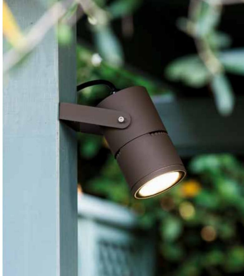
Faretto cilindrico orientabile e con messa a fuoco regolabile, in alluminio. Diffusore in vetro trasparente. Pressacavo PG9. Illuminazione a 1 LED COB 9 W.
