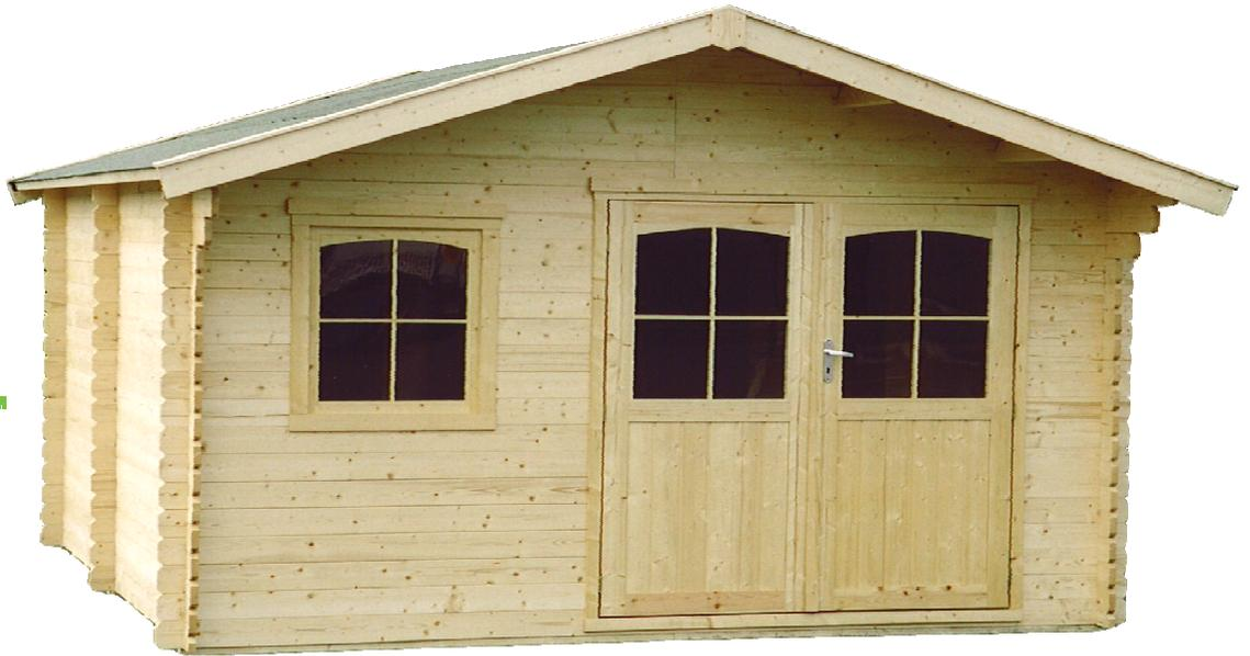
Casetta VALODAN 4,03x3,35 m in legno Abete del Nord Sistema Block House senza Pavimento Struttura in legno massiccio con doppio intaglio Spessore 34 mm Porta doppia fissata su telaio vetri sintetici Tetto in legno massiccio 16 mm Finitura bituminosa da verde 3 mm Pendenza 18 gradi Peso 667 kg
